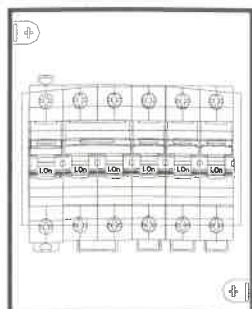
WIDOK ELEWACJI TABLICY POWTARZALNEJ TM 1x6M, IP20(30) NATYNKOWA, II KLASA OCHRONNOŚCI
