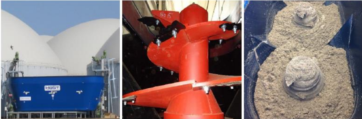
Rys. 3a. System dozowania sypek substratów.
