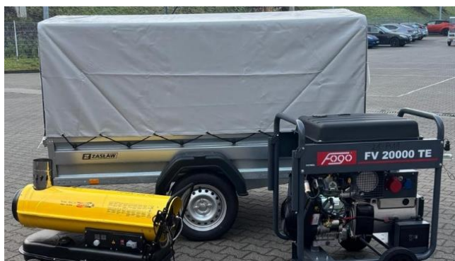
Agregat prądotwórczy 16kV na przyczepie
