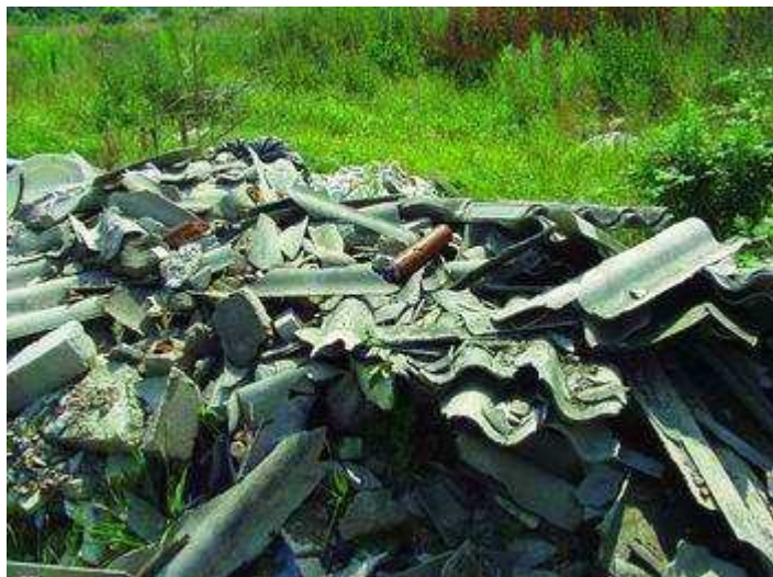
Fot. 12 Przykład dzikiego wysypiska odpadów azbestowych
