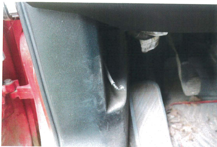
Brak dźwignienki otwarcia pokrywy komory silnika.
