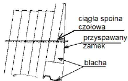
Rysunek 7. Pale specjalne wykorzystywane do zniwelowania pochylenia ścianki
