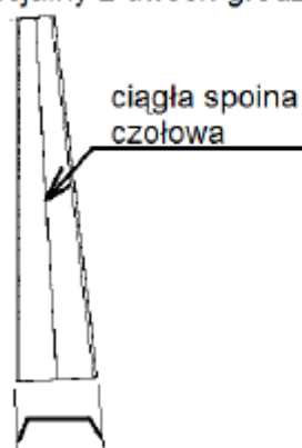
Rysunek 7. Pale specjalne wykorzystywane do zniwelowania pochylenia ścianki
