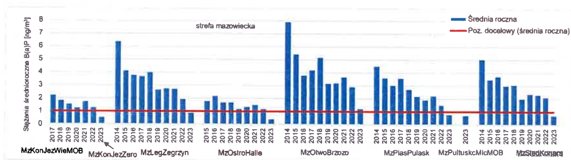
Rysunek 13 Przebieg wartości średnich rocznych stężeń B(a)P w pyłe zawieszonym PM10 na stanowiskach pomiarowych w województwie mazowieckim, na tle poziomu docelowego w latach 2014 – 2023 [źródło: GIOŚ]
